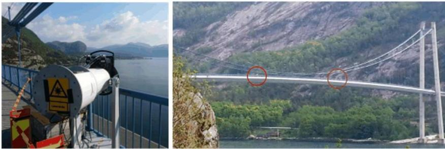
图 1.3 使用测风激光雷达保证大桥建造的安全
