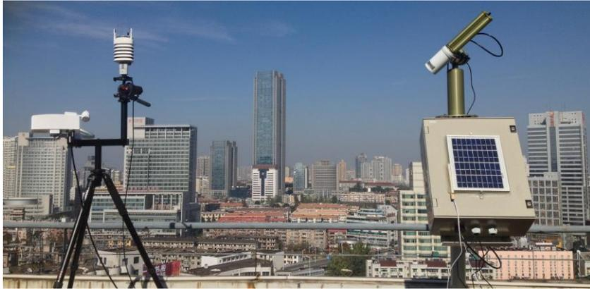
图 62 (左) VAISAL 风速计和能见度仪和 (右) CE-318 型太阳光度计
