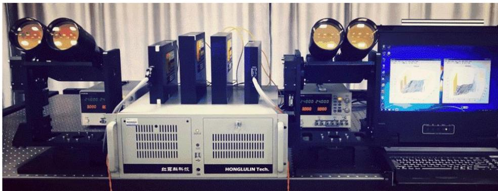
图 41 中国科大研制的  $1.5\mu\text{m}$  相干激光雷达
