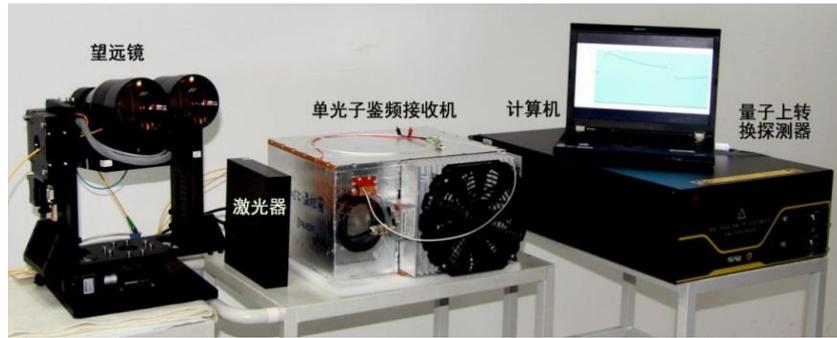
图 16 模块化的  $1.5\mu\text{m}$  直接探测测风激光雷达照片
