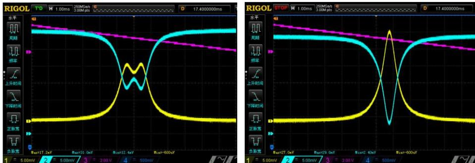
图 53 入射光为非线偏振光时测量的 Fabry-Perot 干涉仪的透射和反射曲线
